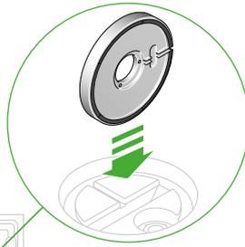
Bringen Sie die Sicherungsschraube an der Unterseite der Basis an. Ziehen Sie die Schraube im Uhrzeigersinn fest.
