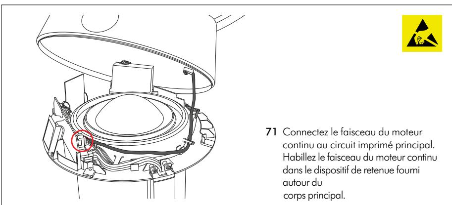
71 Connectez le faisceau du moteur continu au circuit imprimé principal. Habillez le faisceau du moteur continu dans le dispositif de retenue fourni autour du corps principal.
