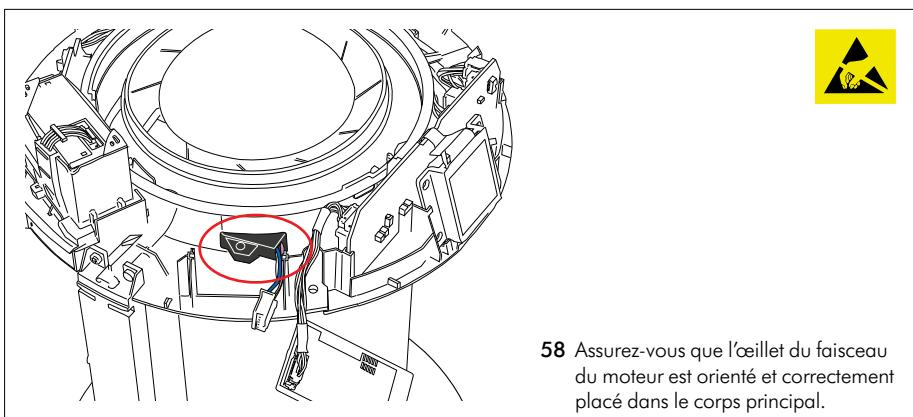
58 Assurez-vous que l'œillet du faisceau du moteur est orienté et correctement placé dans le corps principal.
