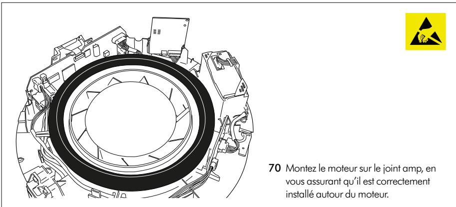
70 Montez le moteur sur le joint amp, en vous assurant qu'il est correctement installé autour du moteur.
