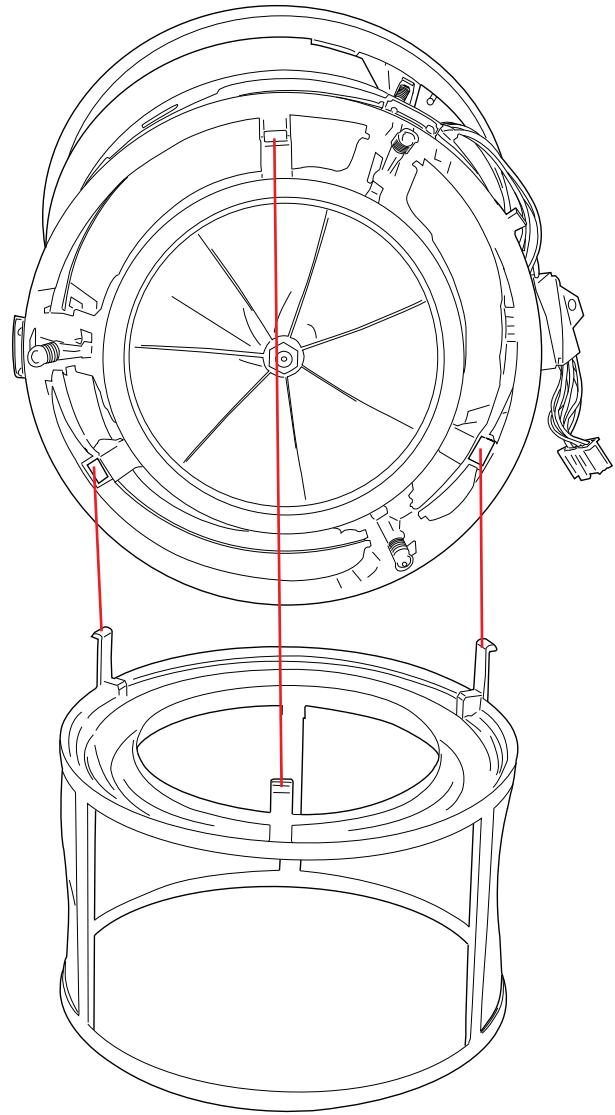
54 Lors de l'installation d'un nouvel ensemble moteur et godet, l'ancien (ou un nouveau) hauban d'entrée de la roue devra être monté.
