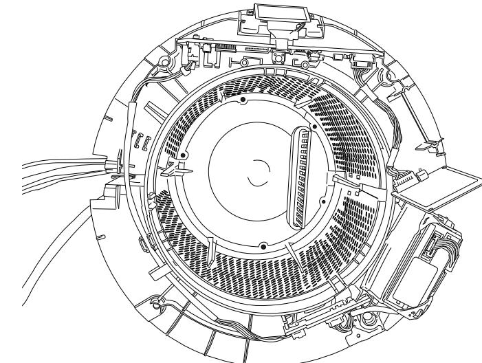
49 Abaissez soigneusement le corps principal sur le corps inférieur en vous assurant que le dissipateur thermique dépasse en sortant de l'espace à la base du corps principal.
