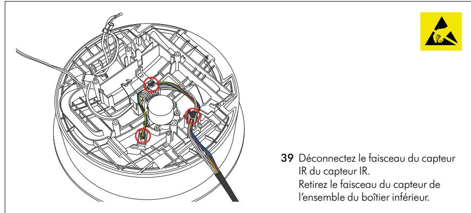
39 Déconnectez le faisceau du capteur IR du capteur IR.
