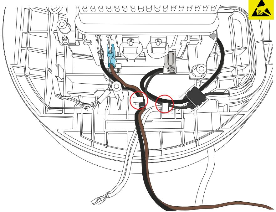
46 Connectez les fils d'alimentation principaux sous tension à l'ensemble du circuit imprimé Triac.
