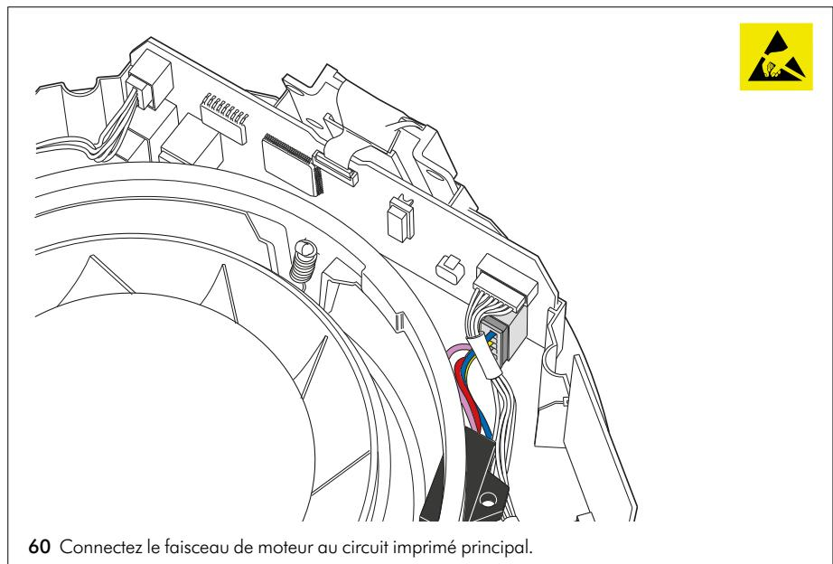
60 Connectez le faisceau de moteur au circuit imprimé principal.
