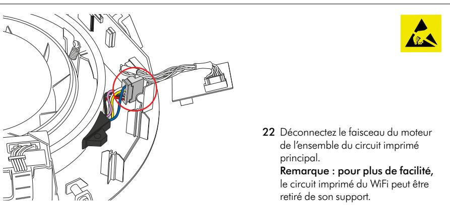
22 Déconnectez le faisceau du moteur de l'ensemble du circuit imprimé principal.
