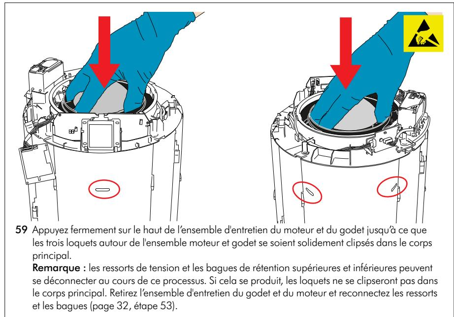
59 Appuyez fermement sur le haut de l'ensemble d'entretien du moteur et du godet jusqu'à ce que les trois loquets autour de l'ensemble moteur et godet se soient solidement clipsés dans le corps principal.
