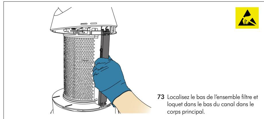
73 Localisez le bas de l'ensemble filtre et loquet dans le bas du canal dans le corps principal.
