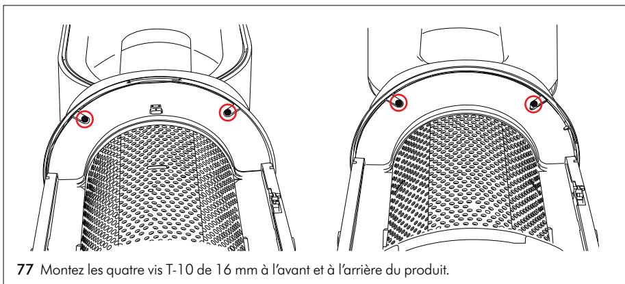
77 Montez les quatre vis T-10 de 16 mm à l'avant et à l'arrière du produit.
