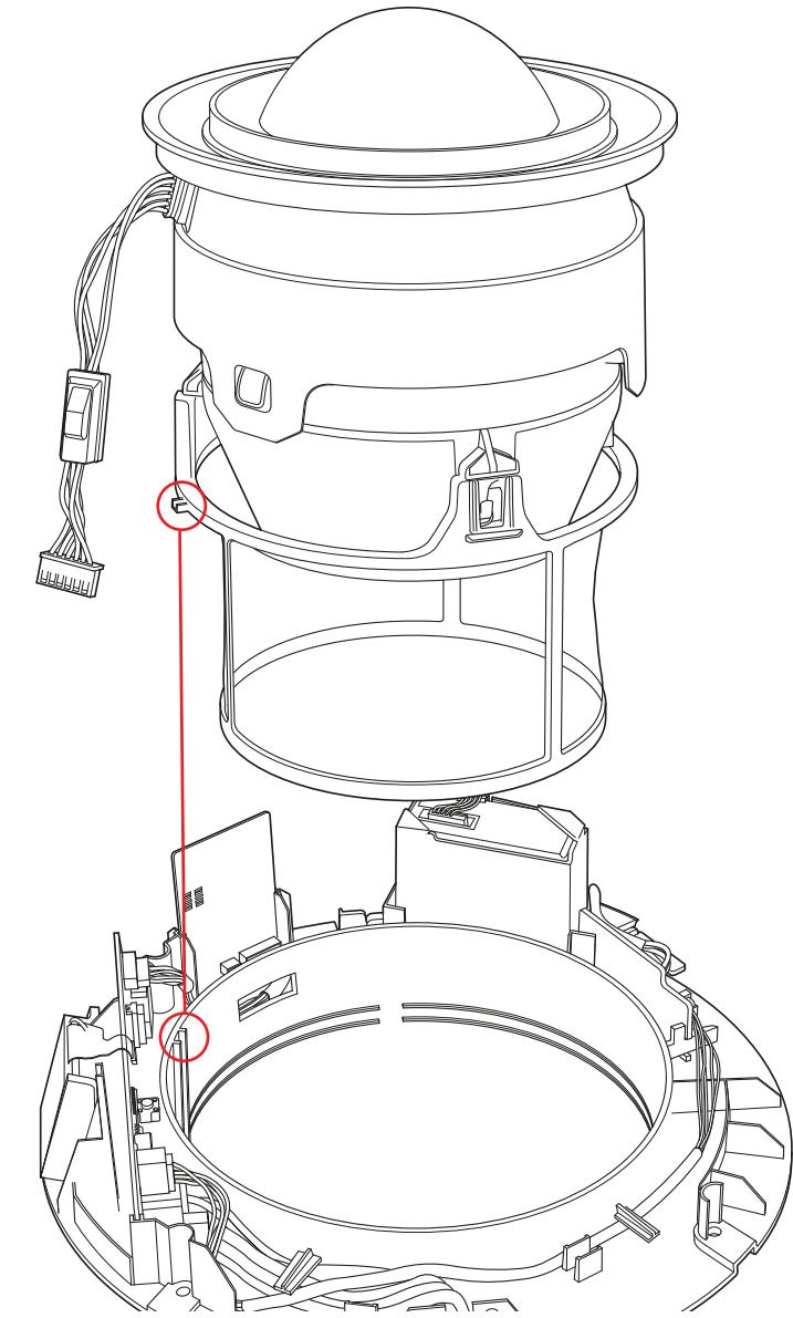
55 Alignez les détails sur le côté de l'ensemble d'entretien du moteur et du godet avec la rainure à l'intérieur du corps principal.
