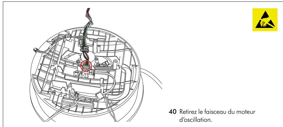
40 Retirez le faisceau du moteur d'oscillation.
