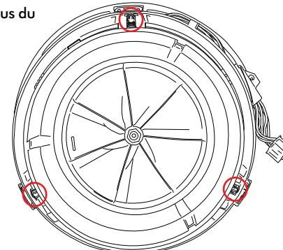
**53 Important :** assurez-vous que les bagues de rétention supérieure et inférieure ainsi que les six ressorts de tension sont correctement situés en haut et en bas de l'ensemble moteur et godet. Le non-respect de cette consigne entraînera l'échec de la réparation.
