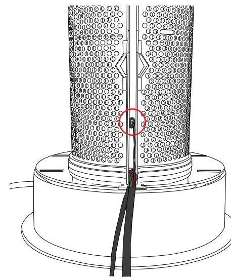
50 Localisez le capteur d'humidité dans l'ouverture sur le côté du corps principal.
