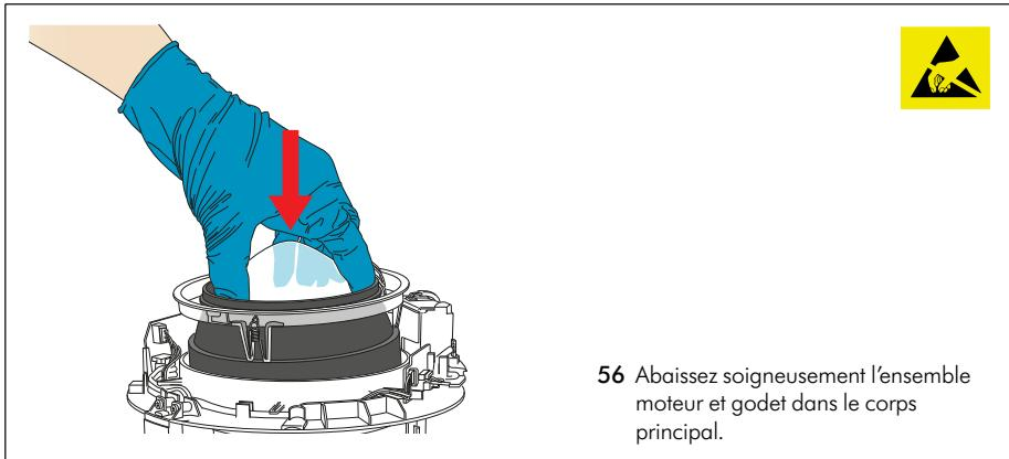
56 Abaissez soigneusement l'ensemble moteur et godet dans le corps principal.
