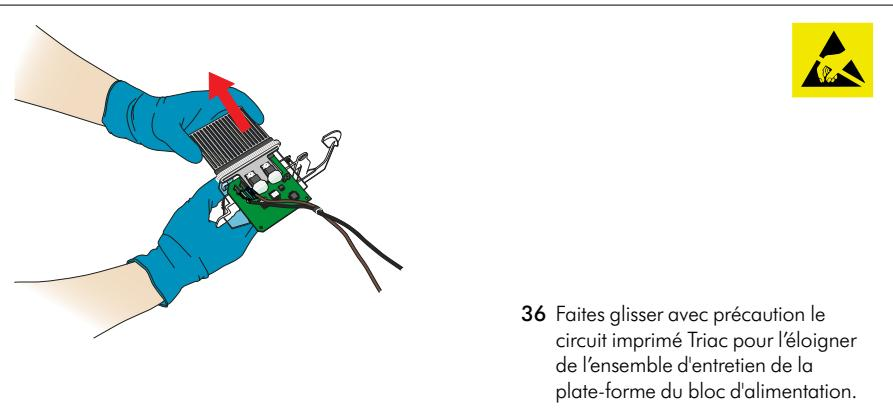
36 Faites glisser avec précaution le circuit imprimé Triac pour l'éloigner de l'ensemble d'entretien de la plate-forme du bloc d'alimentation.
