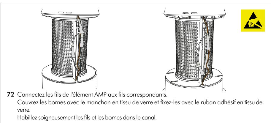
72 Connectez les fils de l'élément AMP aux fils correspondants. Couvrez les bornes avec le manchon en tissu de verre et fixez-les avec le ruban adhésif en tissu de verre. Habillez soigneusement les fils et les bornes dans le canal.
