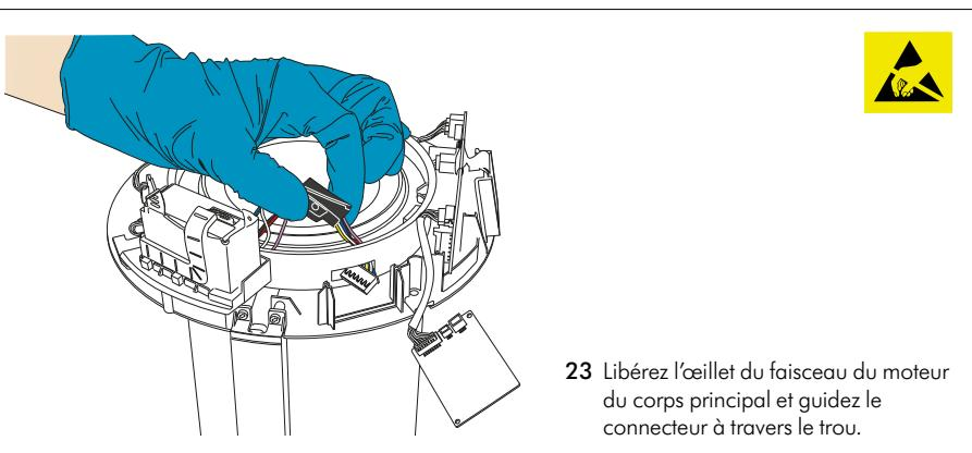
23 Libérez l'œillet du faisceau du moteur du corps principal et guidez le connecteur à travers le trou.
