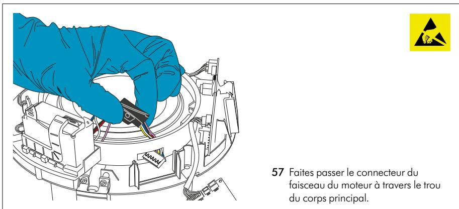
57 Faites passer le connecteur du faisceau du moteur à travers le trou du corps principal.
