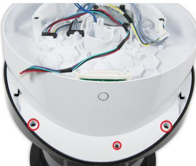
**123** Retirez les six vis T-10 de 12 mm et les deux vis T-6 de 8 mm à l'avant et à l'arrière de la plaque d'inclinaison.
