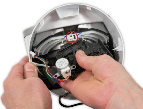
**107** Positionnez l'extrémité du bras de levier du moteur dans le trou de l'ensemble d'entretien du volet de mise au point continue.
