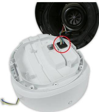
**146** Placez solidement le plus grand œillet du faisceau du moteur dans la plaque d'inclinaison.
