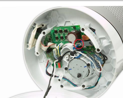
**41** Connectez le faisceau d'oscillation à l'ensemble du circuit imprimé principal.
