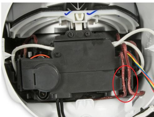
**116** Habillez soigneusement les fils dans les dispositifs de retenue du couvercle de borne.
