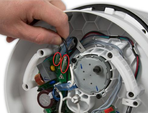
**21** Débranchez soigneusement les fils sous tension et neutre du circuit imprimé principal.
