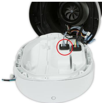
**149** Placez solidement le plus grand œillet du faisceau principal de l'Amp dans la plaque d'inclinaison.
