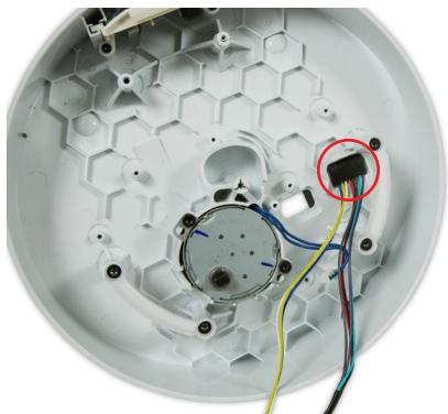
**145** Placez solidement le plus petit œillet du faisceau du moteur dans le boîtier du corps inférieur.
