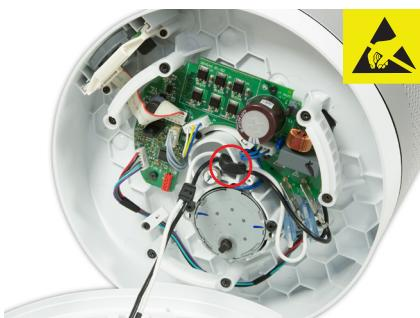
**46** Assurez-vous que le faisceau du moteur d'oscillation est correctement installé.
