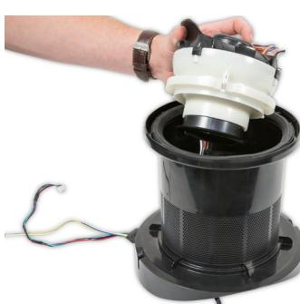
**134** Assurez-vous que tous les faisceaux sont libres du dispositif de retenue à l'intérieur du boîtier du corps principal. Soulevez l'ensemble moteur et godet du boîtier du corps principal.
