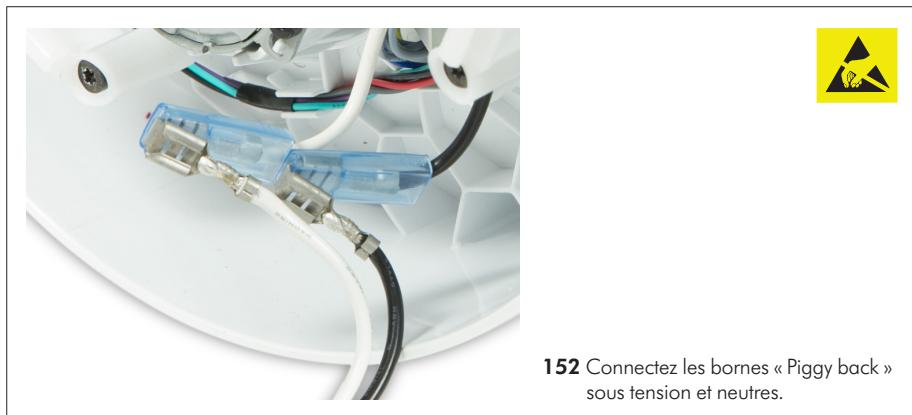
**152** Connectez les bornes « Piggy back » sous tension et neutres.
