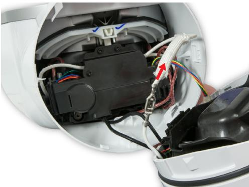
**70** Retirez les fils neutres du support dans l'ensemble godet à moteur.
