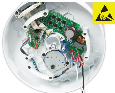
**45** Connectez les fils sous tension et neutre aux bornes « piggyback » correspondantes.
