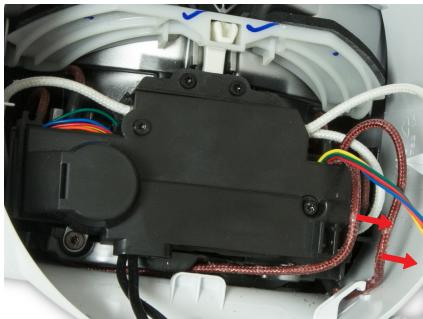
**92** Détachez soigneusement les fils du couvercle de la borne. Retirez les deux vis T-8 du couvercle de la borne. Soulevez le couvercle.
