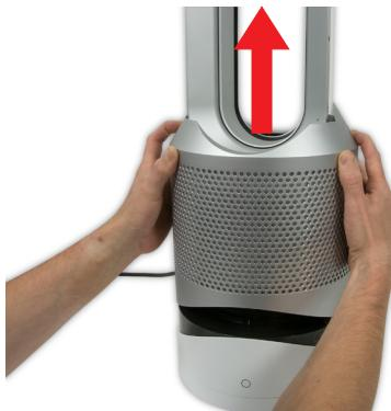
**89** Appuyez sur les boutons de déverrouillage situés de chaque côté de l'ensemble de filtre. Soulevez l'ensemble de filtre au-dessus de l'ensemble AMP.
