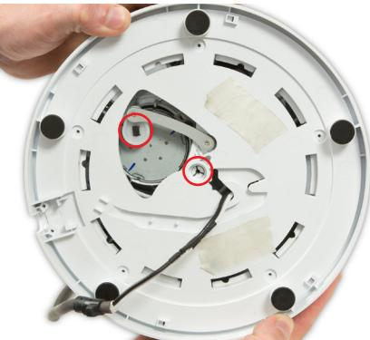
**27** Placez la plaque de base sur le boîtier du corps inférieur. Positionnez la came sur le moteur d'oscillation. Positionnez le centre de la plaque de base sur le bossage de la vis centrale.
