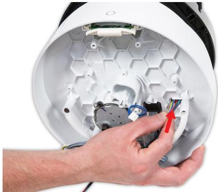
**132** De l'intérieur du boîtier du corps inférieur, faites passer l'œillet du moteur à travers.
