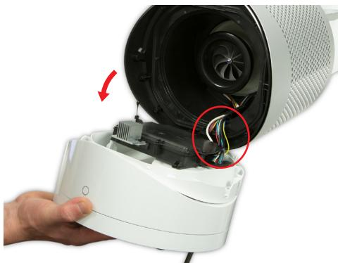
**49** Soulevez avec précaution la plaque d'inclinaison et le boîtier du corps inférieur pour les éloigner du corps principal.
