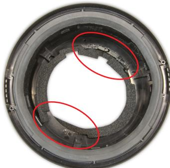
**135** Vérifiez que le joint en mousse du godet à moteur n'est pas endommagé.
