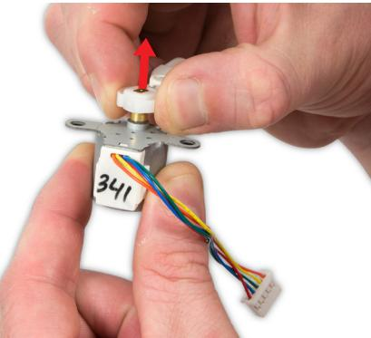
**98** Si la raison de la réparation est de remplacer le moteur en mode continu ou l'un des composants qui y sont attachés, vous devrez les retirer. Refirez le bras de levier de moteur du moteur.
