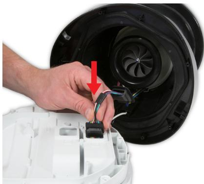
**144** Faites passer le faisceau du moteur à travers la plaque d'inclinaison et dans le boîtier du corps inférieur.
