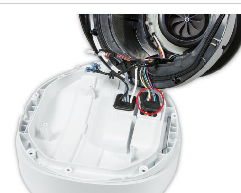
**131** Décollez l'œillet du faisceau du moteur de la plaque d'inclinaison.
