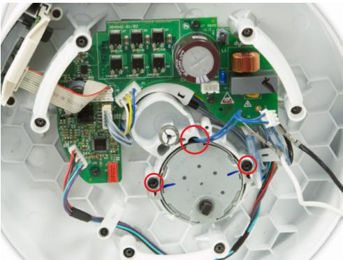
**39** Montez le nouveau moteur d'oscillation et les deux vis T-15. Assurez-vous que le faisceau du moteur d'oscillation est situé dans le canal.
