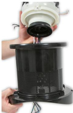
**139** Faites passer les faisceaux de câblage à travers le corps principal.
