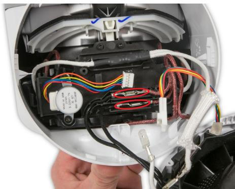
**74** Débranchez soigneusement les deux fils de chauffage.
