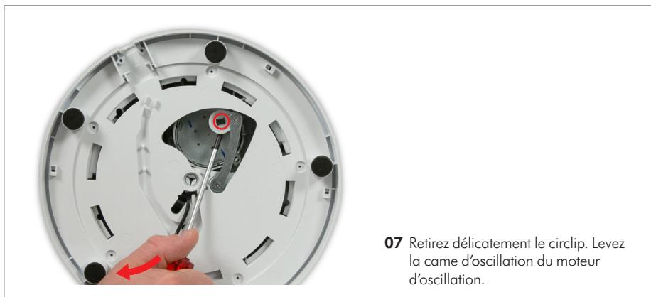
**07** Retirez délicatement le circlip. Levez la came d'oscillation du moteur d'oscillation.
