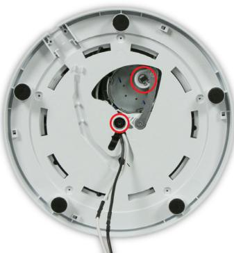
**30** Montez soigneusement le circlip.
