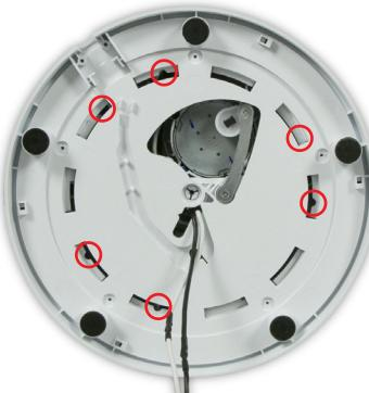
**29** Serrez les six vis T-15 (il faudra orienter la base pour permettre l'accès aux vis).
