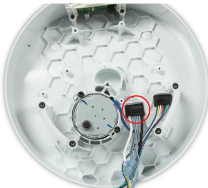
**148** Placez solidement le plus petit œillet du faisceau principal de l'Amp dans le boîtier du corps inférieur.
