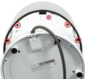
**48** Retirez les six vis T-10 de 12 mm et les deux vis T-6 de 8 mm à l'avant et à l'arrière de la plaque d'inclinaison.
