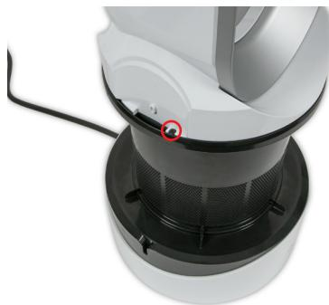
**118** Insérez les deux vis T-8 de 10 mm de chaque côté de l'ensemble Amp.
