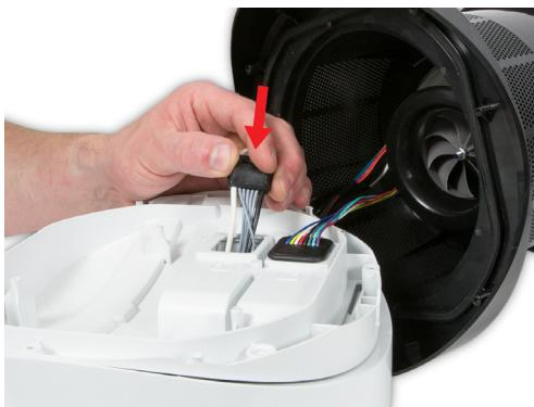
**147** Faites passer le faisceau de l'Amp principal à travers la plaque d'inclinaison et dans le boîtier du corps inférieur.
