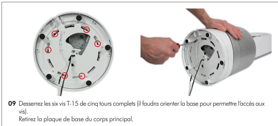
**09** Desserrez les six vis T-15 de cinq tours complets [il faudra orienter la base pour permettre l'accès aux vis].
