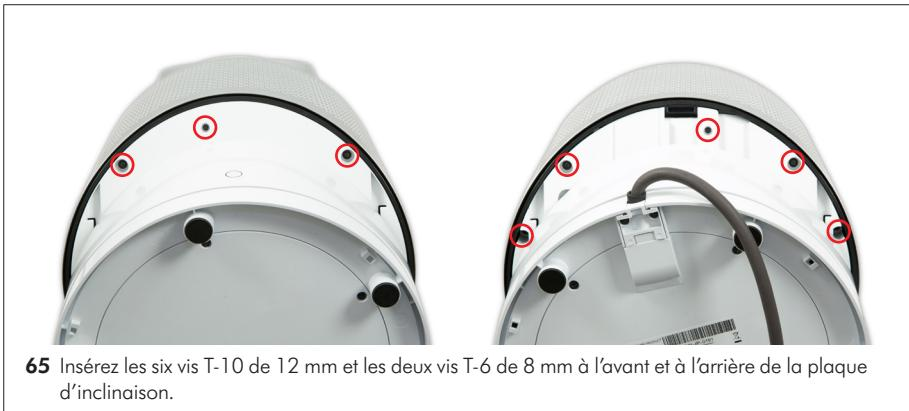
**65** Insérez les six vis T-10 de 12 mm et les deux vis T-6 de 8 mm à l'avant et à l'arrière de la plaque d'inclinaison.
