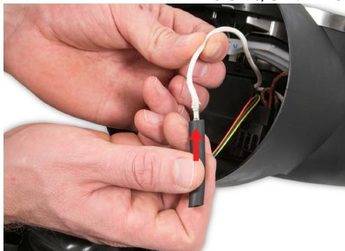
**78** Faites glisser la gaine thermorétractable sur le côté de l'Amp du fil neutre.
