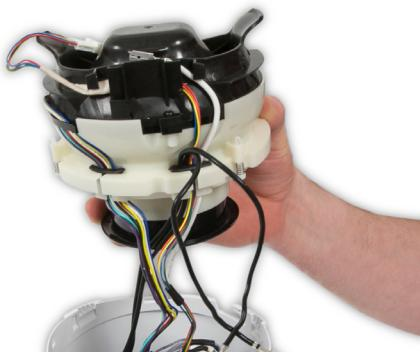
**126** Faites passer les faisceaux de câblage à travers le corps principal.
