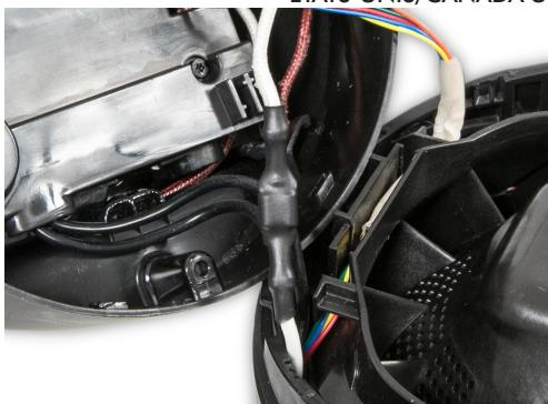
**81** À l'aide d'un pistolet thermique, assurez-vous que la gaine thermorétractable enveloppe entièrement les connecteurs.
