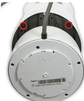
**59** Montez les quatre vis T-10 de 12 mm.
