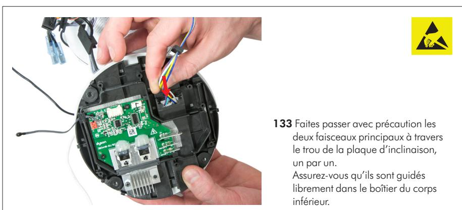
**133** Faites passer avec précaution les deux faisceaux principaux à travers le trou de la plaque d'inclinaison, un par un.
