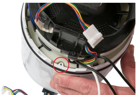
**130** Faites passer les faisceaux de câblage à travers le corps principal.
