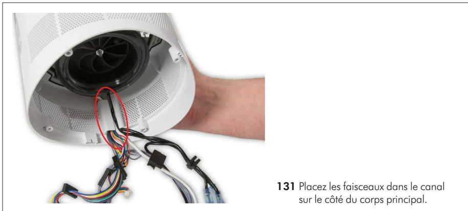
**131** Placez les faisceaux dans le canal sur le côté du corps principal.
