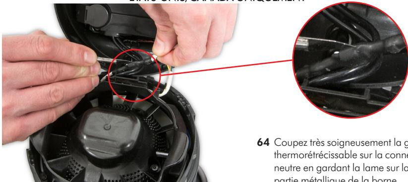
**64** Coupez très soigneusement la gaine thermorétrécissable sur la connexion neutre en gardant la lame sur la partie métallique de la borne.
