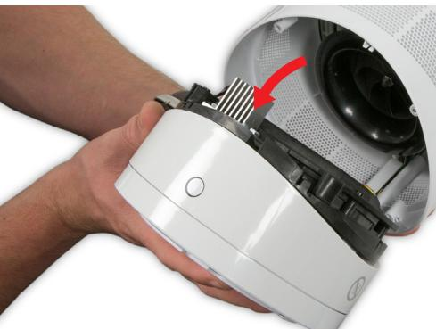
**44** Soulevez avec précaution la plaque d'inclinaison et le boîtier inférieur pour les éloigner du corps principal.
