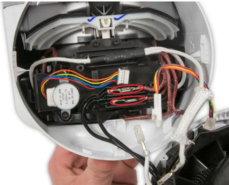
**70** Débranchez soigneusement les deux fils de chauffage.
