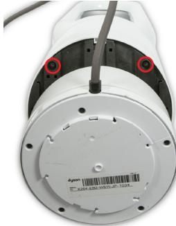
**43** Retirez les quatre vis T-10 de 12 mm à l'avant et à l'arrière de la plaque d'inclinaison.
