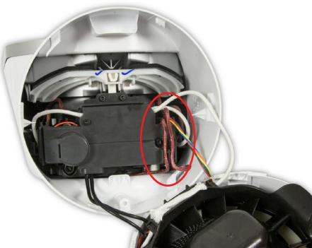
**63** Détachez les fils du dispositif de retenue dans le couvercle.
