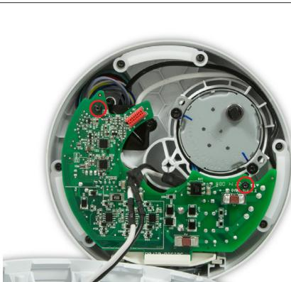
**09** Retirez les deux vis T-8 de 6 mm. Relâchez avec précaution le circuit imprimé et le câble plat du support.
