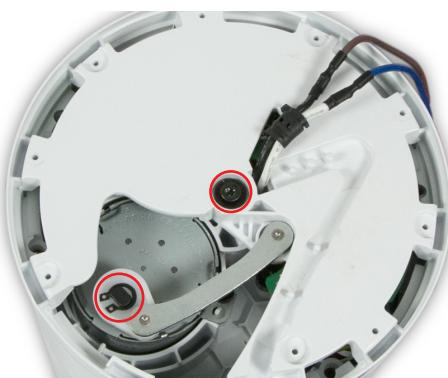
**23** Montez soigneusement le circlip.
