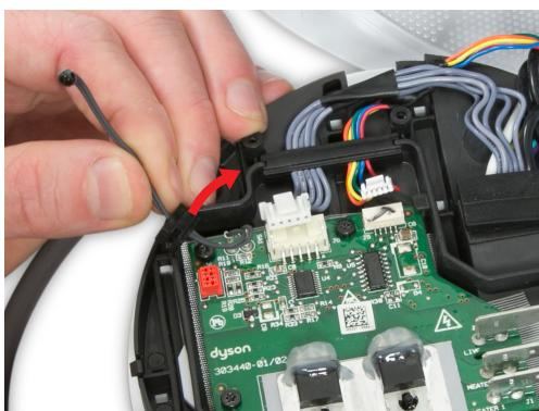
**48** Relâchez avec précaution l'œillet du capteur thermique de la plaque d'inclinaison.
