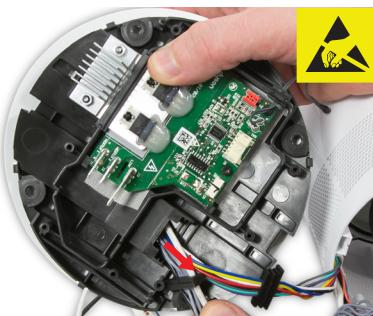
**119** Tirez avec précaution les deux faisceaux à travers le boîtier du corps inférieur et la plaque d'inclinaison.
