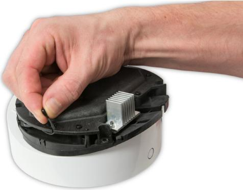
**57** Conservez le capteur thermique dans le couvercle du circuit imprimé.
