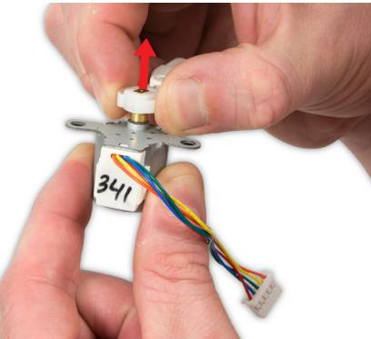
**96** Si la raison de la réparation est de remplacer le moteur en mode continu ou l'un des composants qui y sont attachés, vous devrez les retirer. Retirez le bras de levier de moteur du moteur.
