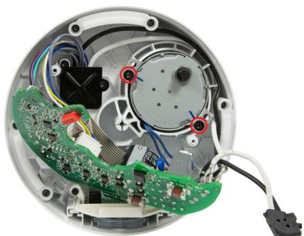
**13** Montez le nouveau moteur d'oscillation et les deux vis T-15 de 12 mm.
