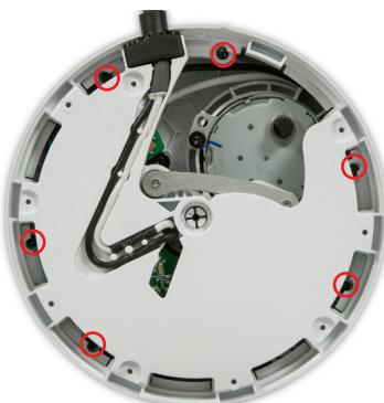
**06** Desserrez les six vis T-8 de six ou sept tours (il peut être nécessaire d'orienter la base pour permettre l'accès aux vis).
