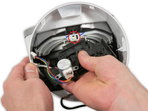
**105** Positionnez l'extrémité du bras de levier du moteur dans le trou de l'ensemble d'entretien du volet de mise au point continue.
