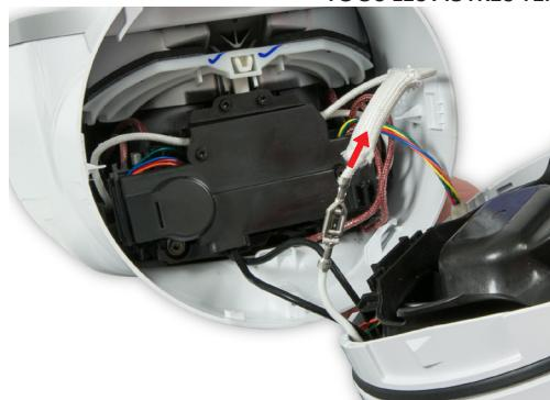
**66** Retirez les fils neutres du support dans l'ensemble godet à moteur. Faites glisser le manchon isolant loin des bornes neutres.
