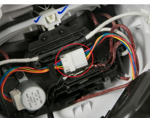
**73** Habillez soigneusement les fils dans les dispositifs de retenue fournis dans le support de borne.
