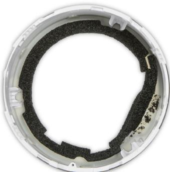
**122** Vérifiez que le joint en mousse du godet à moteur n'est pas endommagé. Si le joint en mousse du godet à moteur n'a pas besoin d'être remplacé, passez à l'étape 130.
