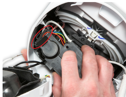
75 Inserire con cautela la sporgenza del coperchio nella fessura della piastra terminale. Importante: è fondamentale che non vi siano fili incastrati tra il coperchio e la piastra.
